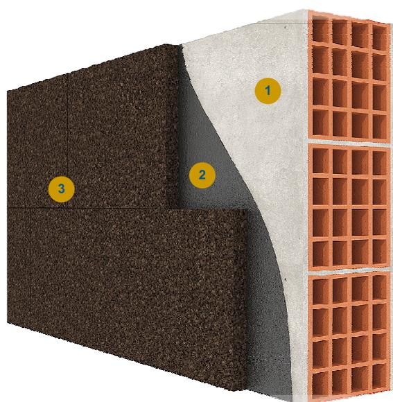
1 Parede    2 Fixação    3 Aglomerado Negro de Cortiça - Tipo REV
