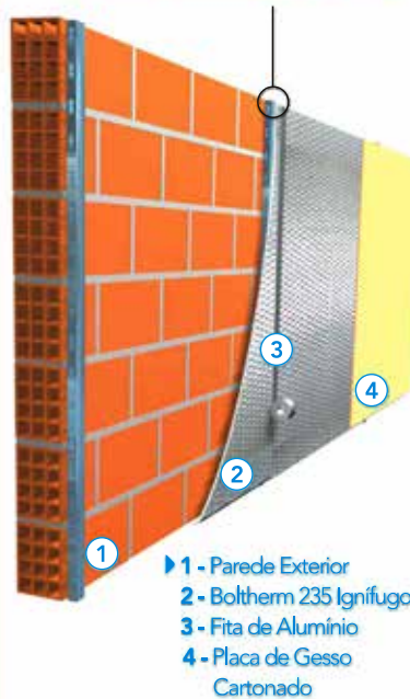
Pormenor de acabamento da aplicação Boltherm 235 Ignífugo
